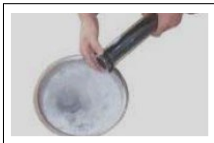
Змастити відкритий кінець вакуумної трубки і пильовик мильним розчином
